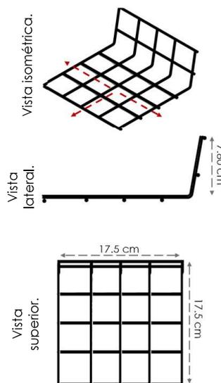
Figura 8: Conexión 4 vías.
