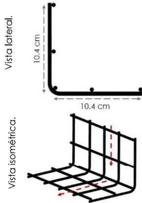
**Figura 10:** Conexión superior.
