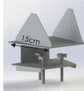
Figura 3: Sujeción inferior.
